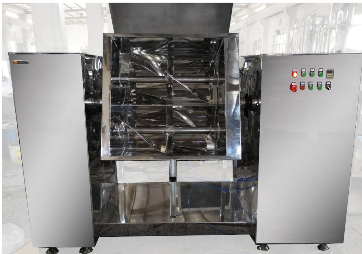
Предназначены для перемешивания различных масс высокой вязкости, таких как: крутое тесто, пряничное тесто, песочное тесто и др. Используются на предприятиях по производству мясных полуфабрикатов и макаронных изделий. Благодаря двум месильным органам обеспечивается лучший промес массы, исключается «налипание» массы на месильные органы. Тестомесы имеют две скорости работы, 20 и 40 об./мин.
